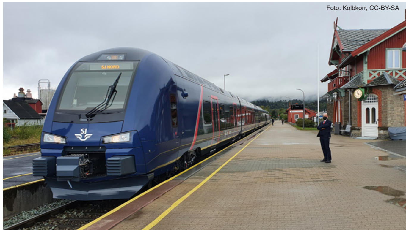
SJ Norge Type 76 på Stjørdal station norr om Trondheim. Ett hybridtåg som kan drivas på både el och diesel och gör det möjligt med fler direktförbindelser utan att behöva köra dieseltåg på elektrifierade banor. .
